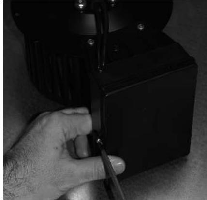
Druck (und Frequenz) können am Schaltkasten geändert werden. Dazu wie folgt vorgehen:
