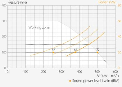
— setting « 50 Pa » examples: setting « 100 Pa » the limit of the working zone determines the maximum airflow / pressure available at the fan ----- setting « 150 Pa »
